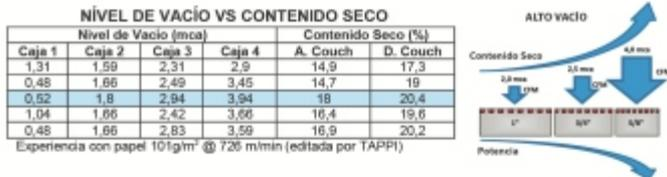
Con el objetivo de mejorar la eficiencia de drenaje, estas cajas pueden tener dos o tres zonas de succión, donde la hoja pasa de una zona de vacío a la próxima sin perder la presión provocada por la primera, ganando de esta forma eficiencia para un mismo nivel de vacío aplicado.
